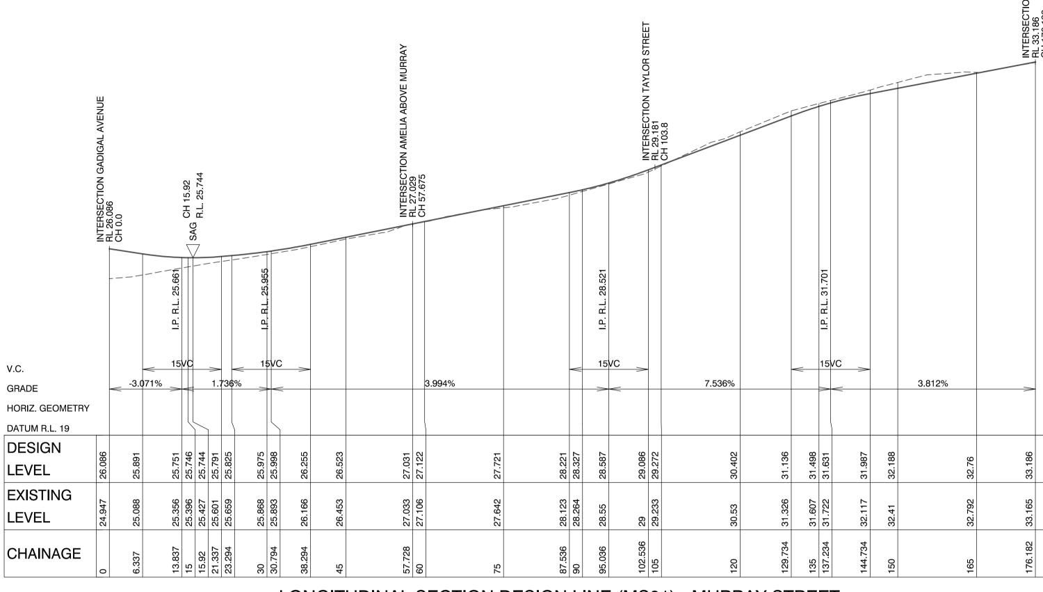
LONGITUDINAL SECTION DESIGN LINE (MS01) - MURRAY STREET SCALE 1:100 (V)
