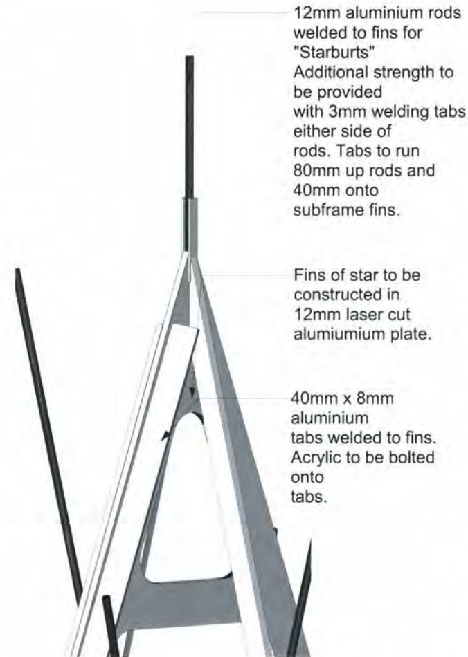
STARBURST SUBFRAME DETAIL Scale: 1:5
